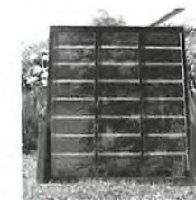
รูปที่ 10 แผงเซลล์แสงอาทิตย์ชนิดสีย้อม (Dye-Sensitized Solar cell)
