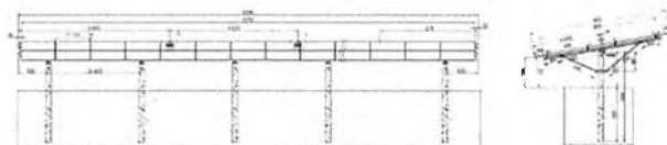
รูปที่ 22 แบบโครงสร้างรองรับแผง
